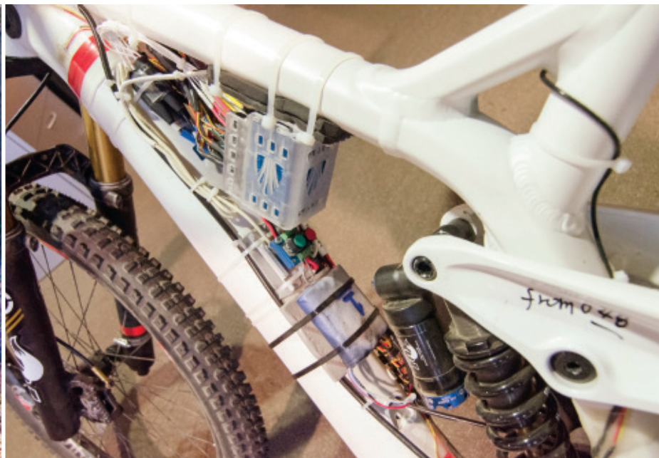
図 1 (左) Abaqus と True-Load のシミュレーションでは、自転車の荷重ケースを試験するために最も厳しい 2 つのコースが用いられた。Deer Hunter コース (上図: 自転車とライダーが高台から地面に飛び降りようとしている) では、リアサスペンションが完全に圧縮され、Mojo コースでは、同様にジャンプするがライダーは自転車を回転させることができる。図 2 (右) 自転車フレームに取り付けられたひずみゲージ
