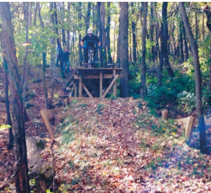
図 1 (左) Abaqus と True-Load のシミュレーションでは、自転車の荷重ケースを試験するために最も厳しい 2 つのコースが用いられた。Deer Hunter コース (上図: 自転車とライダーが高台から地面に飛び降りようとしている) では、リアサスペンションが完全に圧縮され、Mojo コースでは、同様にジャンプするがライダーは自転車を回転させることができる。図 2 (右) 自転車フレームに取り付けられたひずみゲージ
